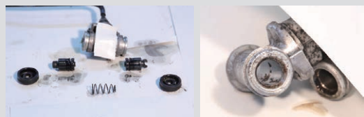
ホイール・シリンダーのカップ損傷により、ブレーキ液の液漏れに至る恐れがあります。
