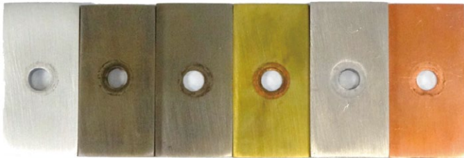
アルミニウム Aluminum 鋳鉄 Cast iron 鋼 Steel 黄銅 Brass はんだ Solder 銅 Copper
